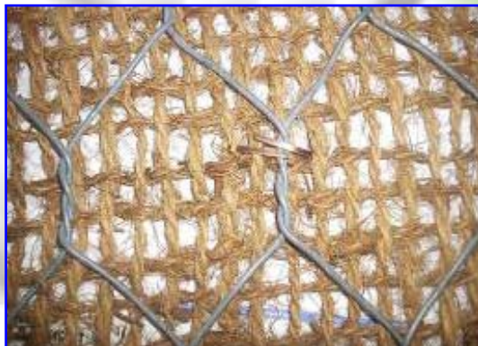
Foto 8 – R.E.C.S.™ - R.F. con cocco ignifugato 800 gr/mq
