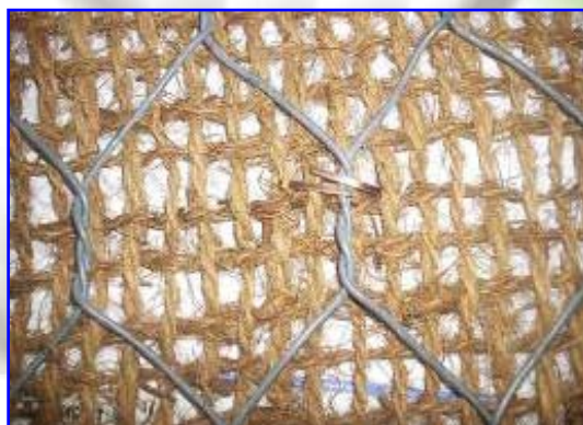
Foto 8 – R.E.C.S.™ - R.F. con cocco ignifugato 800 gr/mq
