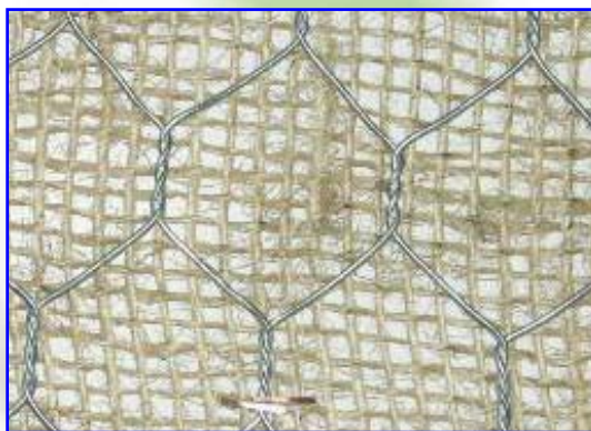
Foto 7 – R.E.C.S.™ Standard con agave 700 gr/mq
