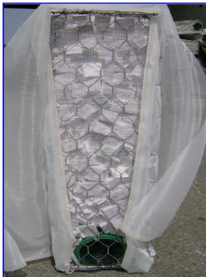
**GEOTESSILE DI RIVESTIMENTO**
