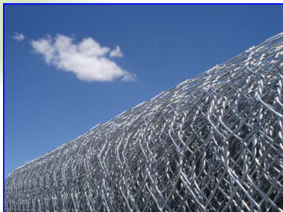
Foto 2 – Rete metallica in trafilato di ferro in maglia esagonale a doppia torsione utilizzata in campo faunistico
