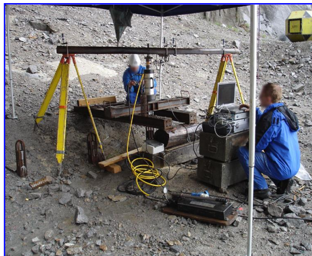
Foto 4 – Campo prove con installazione della postazione di trazione e acquisizione dati
