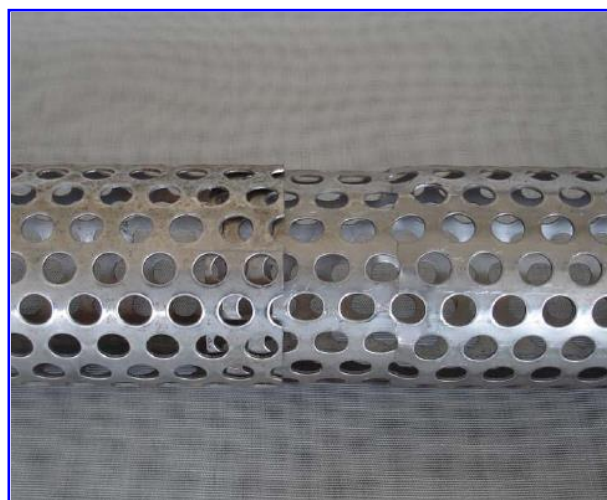
Foto 1 - Tubo fessurato - dettaglio dell'innesto tra due spezzoni
