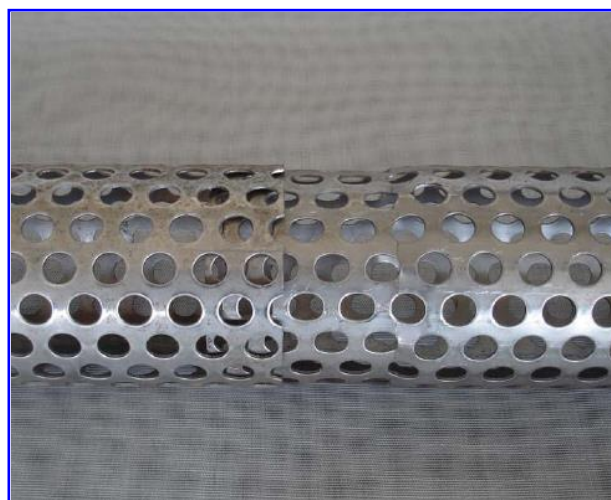
Foto 1 - Tubo fessurato - dettaglio dell'innesto tra due spezzoni
