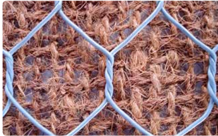
Geocomposito antierosivo per applicazioni idrauliche R.E.C.S. IDRO realizzato in rete metallica a doppia torsione maglia 6x8 e biorete tessuta in cocco 700gr/m 2
